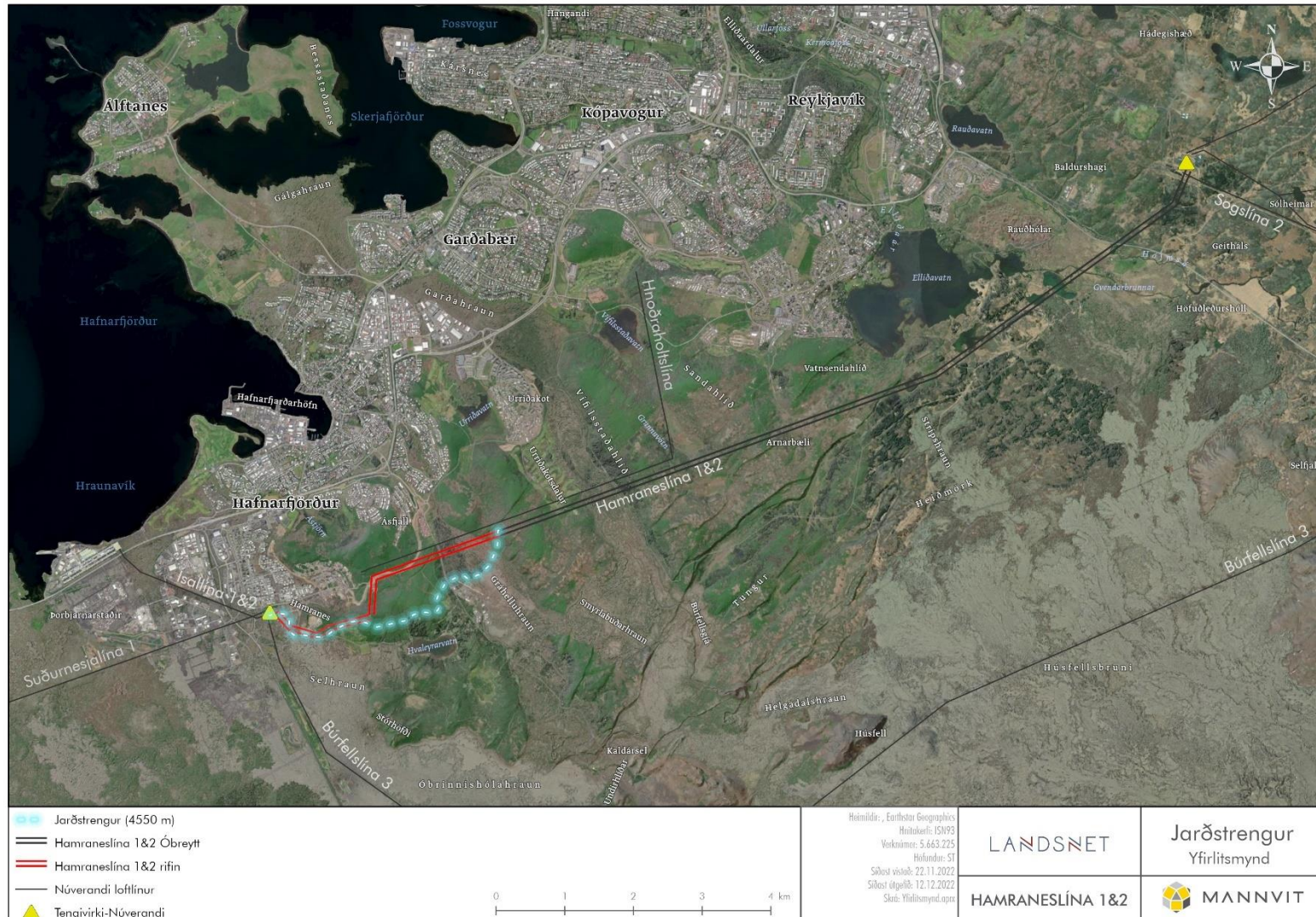
Mynd 3.1 Hamraneslínur lagðar í jörðu frá Hamranesi að Urriðakotsdal og niðurrif 14 mastra.
